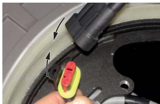
**Riconnettere** il connettore della testa - **Reconnect** the head connector - **Rebranchez** le connecteur de tête - **Schließen** Sie den Kopfstecker wieder an - **Vuelva** a conectar el conector de la cabeza - **Reconecte** o conector da cabeça - **Ponownie** podłącz złącze głowicy - **Подсоедините** разъем головки.
